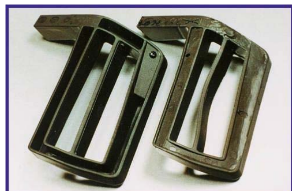
Rys. 6 Wypaczenie wyrobu spowodowane złe dobranymi grubościami ścian
