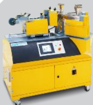
3-warstwowy wylew folii Ultra Mikro (A-B-C), (A-B-A)
