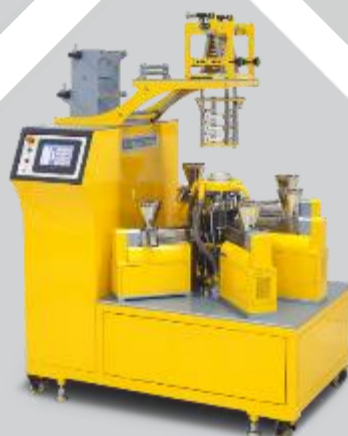
5-warstwowy rozdmuch folii Ultra Mikro (A-B-C-D-E)
