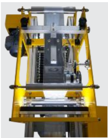
LWIS1000-8K System wysokiej precyzji inspekcji folii
