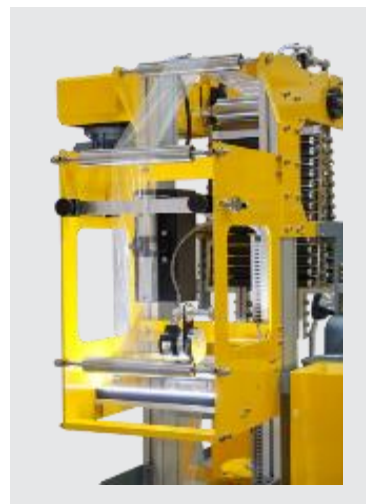
LWIS1000-8K System wysokiej precyzji inspekcji folii
