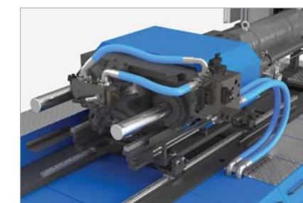
Uproszczona konstrukcja jednostki wtryskowej
